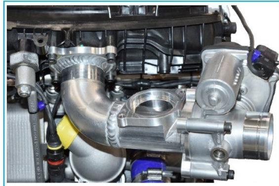
C11-10) Tube contrôle suralimentation FIA - Monté dans son emplacement FIA boost control pipe - Mounted in its location
